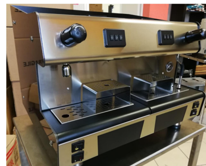
Bacs de récupération des capsules sur la partie frontale sous le bassin
