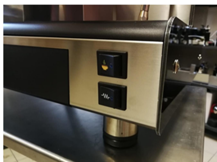
Boutons sur la partie frontale pour couper individuellement la chauffe des échangeurs thermiques (groupe café)
