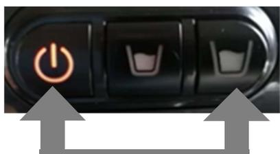
**A/** En position stand-by (bouton « On/Off » rouge) appuyer simultanément sur les boutons « On/Off » et « tasse longue »
