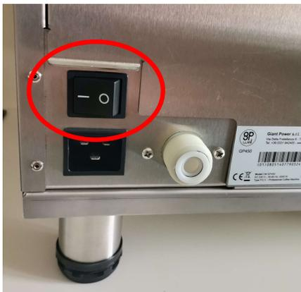
1- Machine éteinte, appuyez simultanément sur le bouton On/Off (T1) du groupe correspondant en allumant la machine avec l'interrupteur général à l'arrière,
